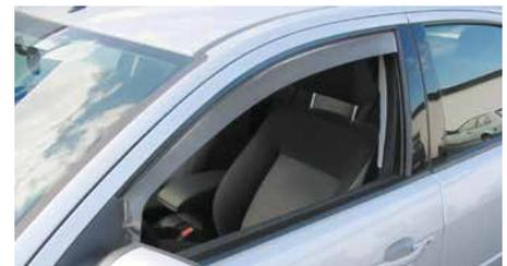
**7 » SEITENWINDABWEISER, AEROLIFT**
