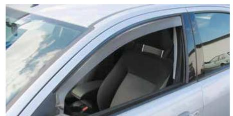
**6 » SEITENWINDABWEISER, AEROLIFT**
